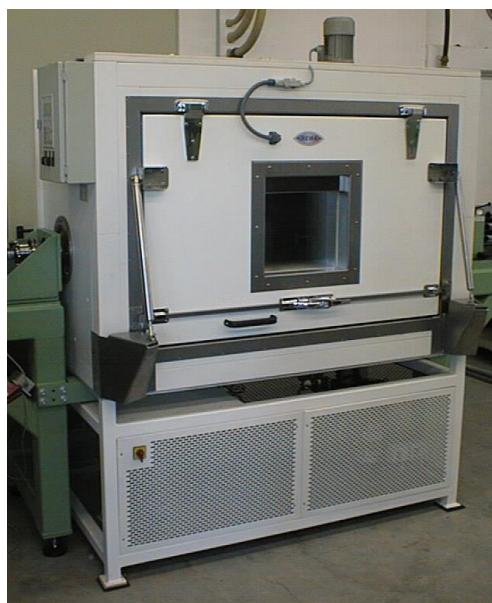
Prüfvorrichtung SPM-1311 für Unterwassertests an Gelenken und Lenkern
