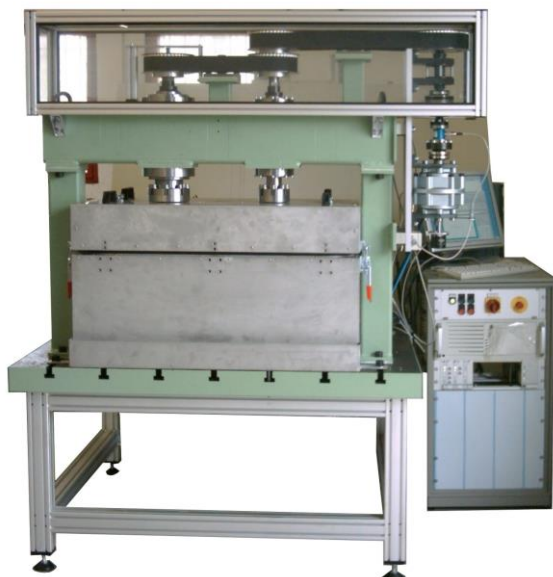
Prüfvorrichtung SPM-1818 für Unterwassertests an Gelenken und Lenkern
