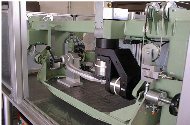
Reibmomentenmessmaschine RMM für Fahrwerksgelenke für den Einsatz im Temperaturbereich von RMM-1422 für Fahrwerksgelenke  $-30 \dots +80^{\circ}\text{C}$
