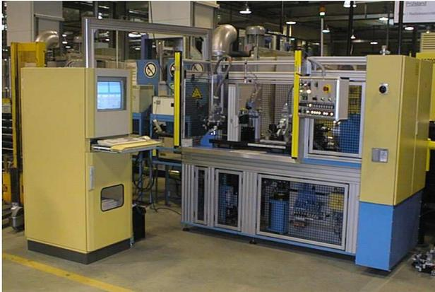
Halbautomatische Elastizitätsmessmaschine EMM-1423 für Fahrwerkslenker
