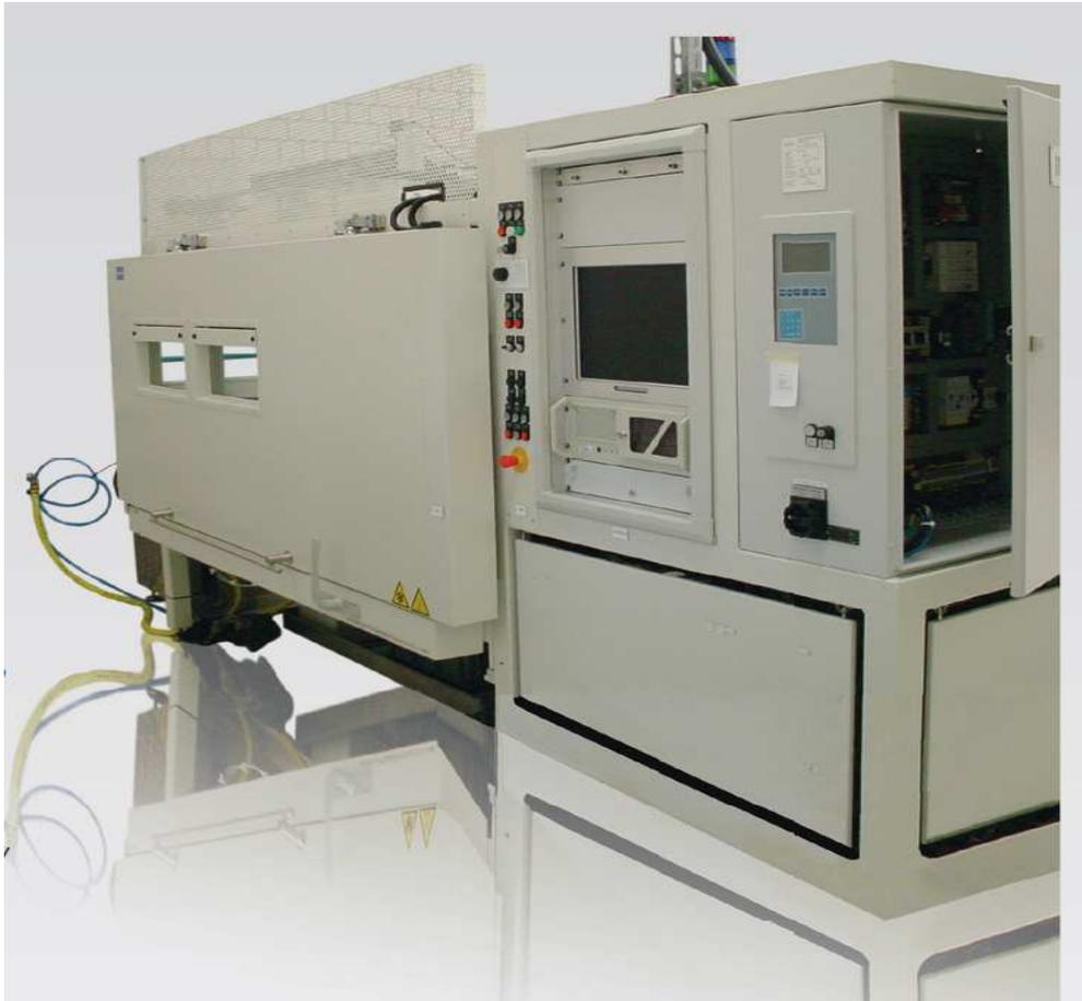
Dichtheitsprüfmaschine DPM6 für Fahrwerkslenker und -gelenke mit Servomotorantrieben
