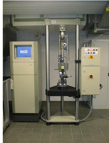
Elastizitätsmessmaschine EMM-1291 für Fahrwerkslenker mit hydraulischer Spanneinrichtung
