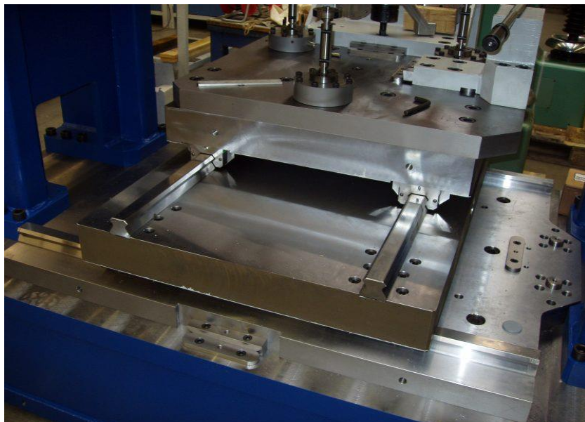
Bild 6: Montage der Prüfplattform und der x ; y Achsführungen
